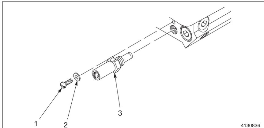
Fig. A 9-12 Substituir a Válvula de Drenagem
