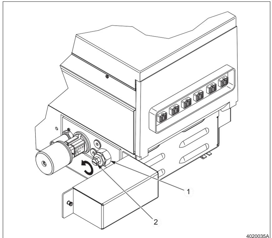
Fig. A 9-7 Removendo a Válvula de Controle de Pressão
