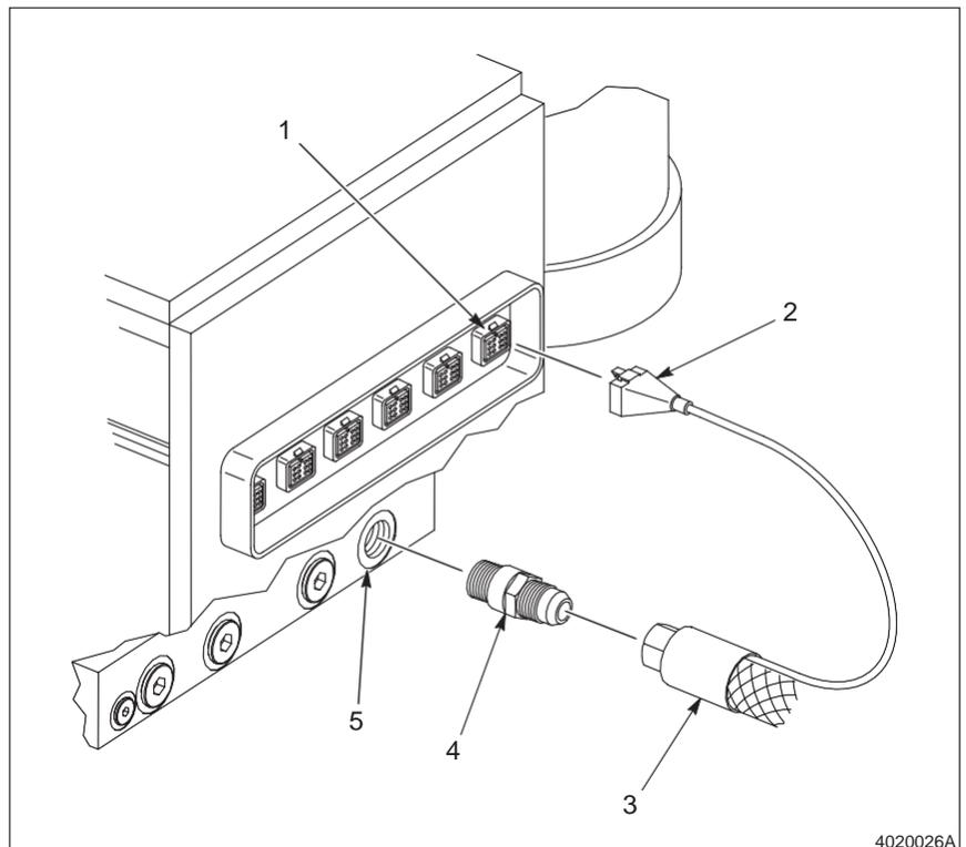
Fig. A 3-3 Colocando a Mangueira de Fornecimento no Processador
