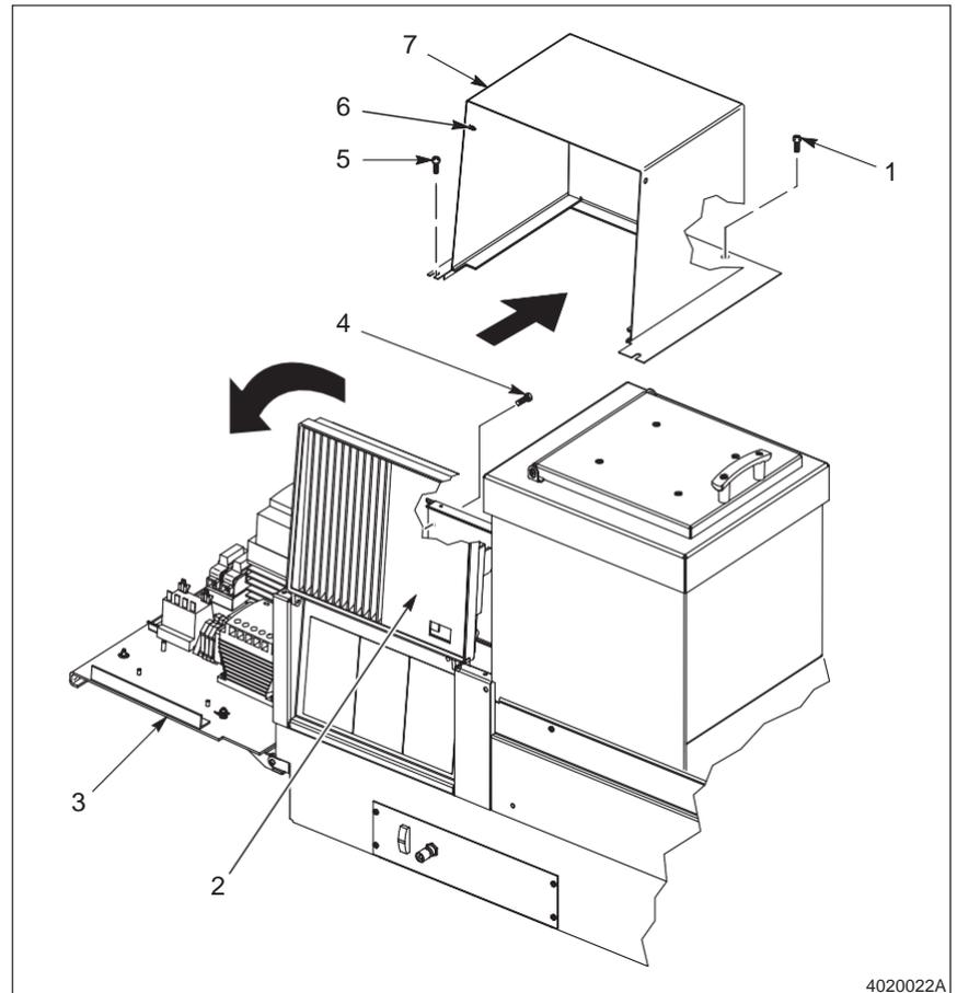
Fig. A 9-15 Abrindo o compartimento elétrico
