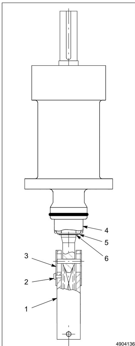
1. Com o conjunto de acionamento fora do processador, remover o parafuso cabeça panela (2) que seguram a manga de retenção (3) no acoplamento de acionamento (1). Remover a manga de retenção.
