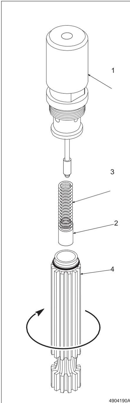
Fig. A 9-10 Desmontando o controlador de densidade
