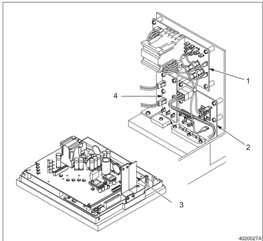
Fig. A 2-5 Placas Específicas da Unidade and Placa I/O
