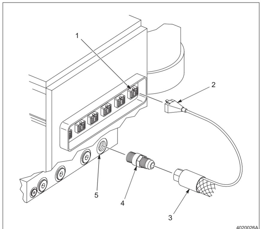
Fig. A 9-13 Substituição do Anel O do Conector da Mangueira
